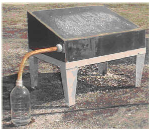
Fig. 1. Destilador solar de 0,8 L/día.
