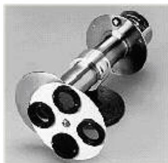
*Figura 2. Pirheliómetro Eppley.*
