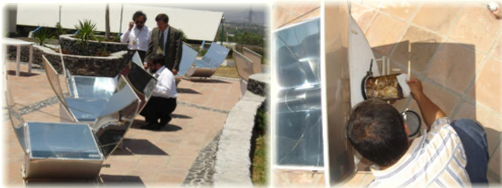
*Fig. 2. Hornos solares Tolokatsin 1 de 12 litros de capacidad, empleados en una comida solar para más de 260 comensales.*
