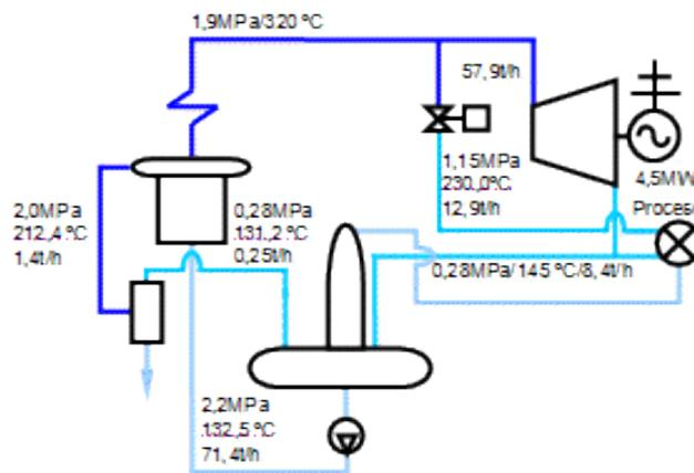
Fig. 2. Esquema térmico de cogeneración para la alternativa B.
