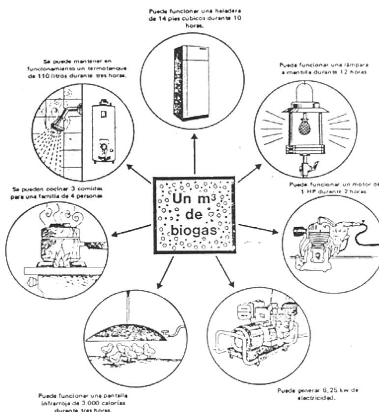
Fig. 3. Diferentes aplicaciones de 1 m<sup>3</sup> de biogás (Tomado de Manual para la producción de biogás, Jorge A. Hilbert).
