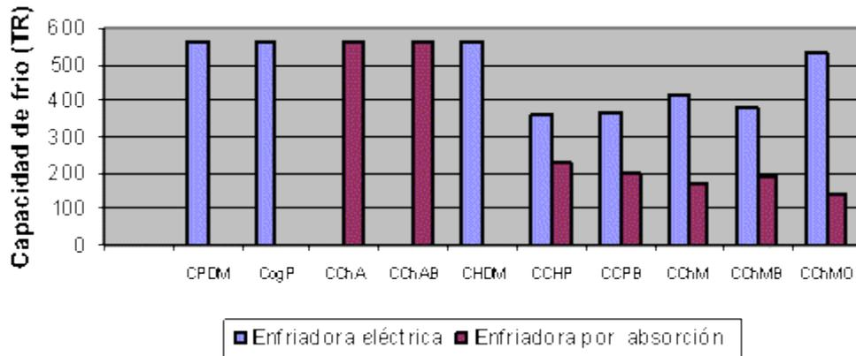
*Fig. 8. Capacidad instalada de enfriadoras eléctricas y de absorción para un hotel, utilizando diferentes métodos para realizar el dimensionado.*
