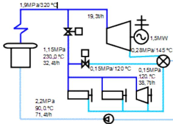
Fig. 1. Esquema térmico de cogeneración para la alternativa A.
