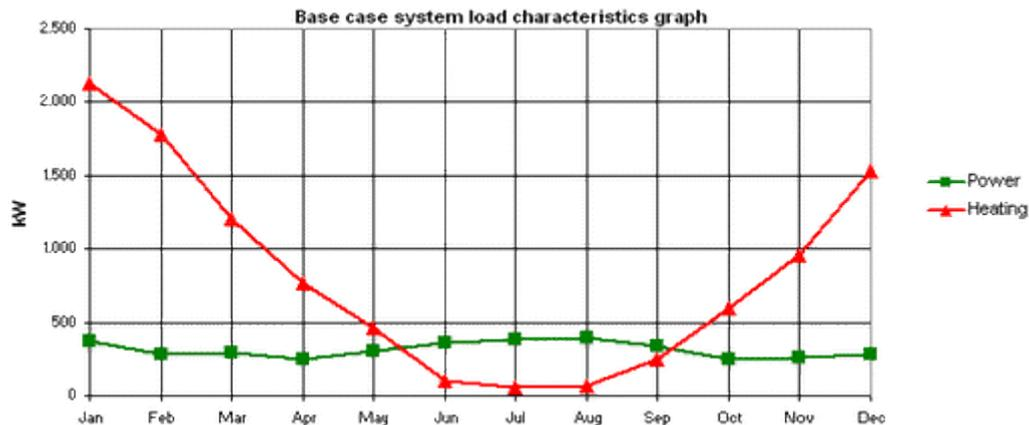
Fig. 4. Demandas típicas de potencia y calor en edificaciones localizadas en países con más experiencia en sistemas de cogeneración [Fuente: [www.retscreen.net](http://www.retscreen.net)].
