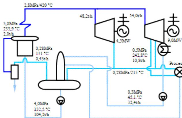
Fig. 4. Esquema térmico de cogeneración para la alternativa D.
