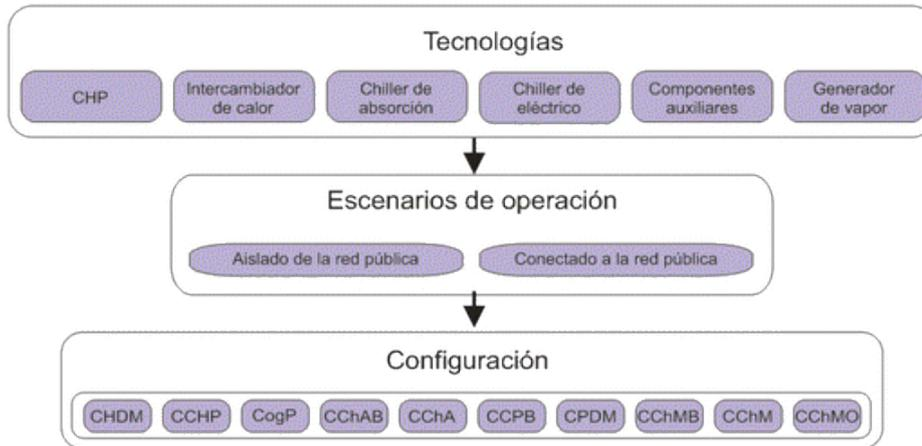
*Fig. 6. Aspectos que se deben tomar en cuenta en una correcta selección y dimensionado de sistema de cogeneración para edificaciones.*
