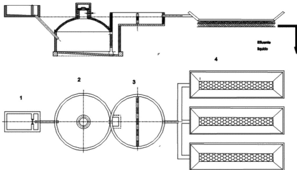
Fig. 1. Sistema de tratamiento de residual porcino digestor-lecho de secado.
