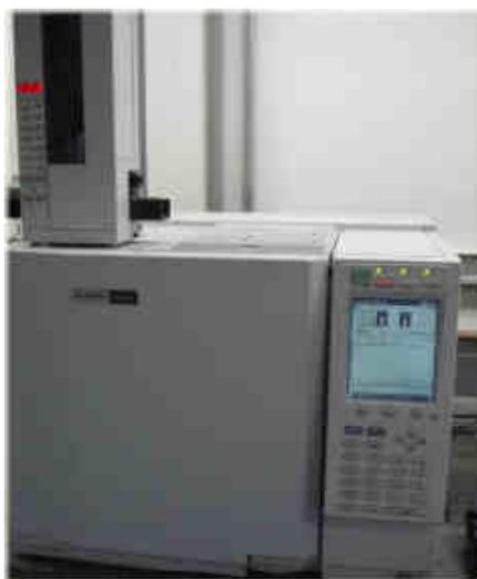
*Fig. 2. Cromatógrafo GC Shimadzu, modelo GC2010.*
