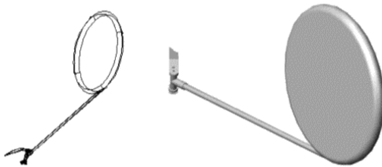
Fig. 7. Propuesta de veleta para la variante actualizada del aerogenerador CEETA-01.
