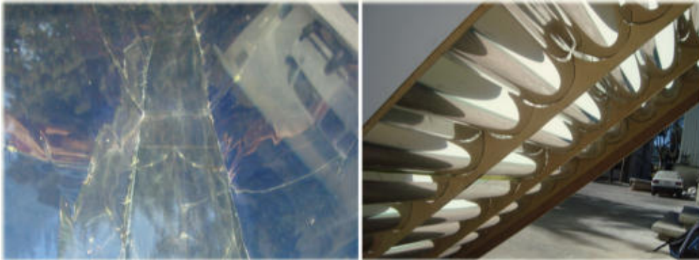
Fig. 8. Izquierda: Close-up de un canal CPC. Derecha: Vista trasera del captador mostrando los espejos de sección circular (previo a la aplicación del aislamiento térmico).
