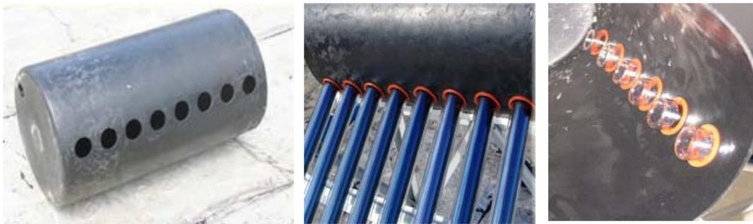
*Fig. 4. Etapas constructivas del prototipo.*
