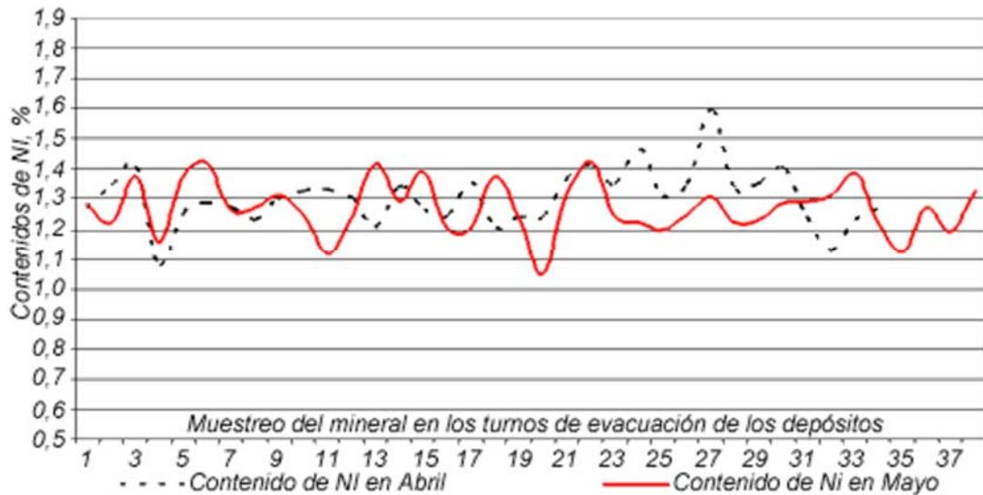
Fig. 3. Contenido de níquel en el mineral evacuado de los depósitos, en abril y mayo de 2006.
