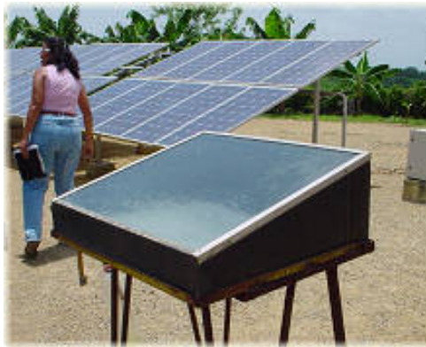
Fig. 1. Destilador solar en funcionamiento en el poblado Santamaría del Loreto, Santiago de Cuba.
