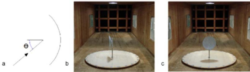
*Fig. 3. Antenas parabólicas en túnel de viento,
