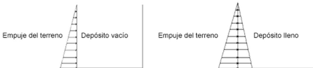
Fig. 5 Estado de carga 1. Depósito vacío. Estado de carga 2. Depósito lleno
