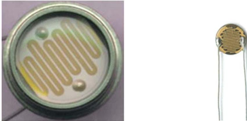
Fig. 2. Foto resistor.
