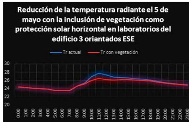
*Fig. 18. Temperatura radiante simulada en los laboratorios orientados al ESE en el edificio 3, con los elementos de protección solar originales y modificados.*
