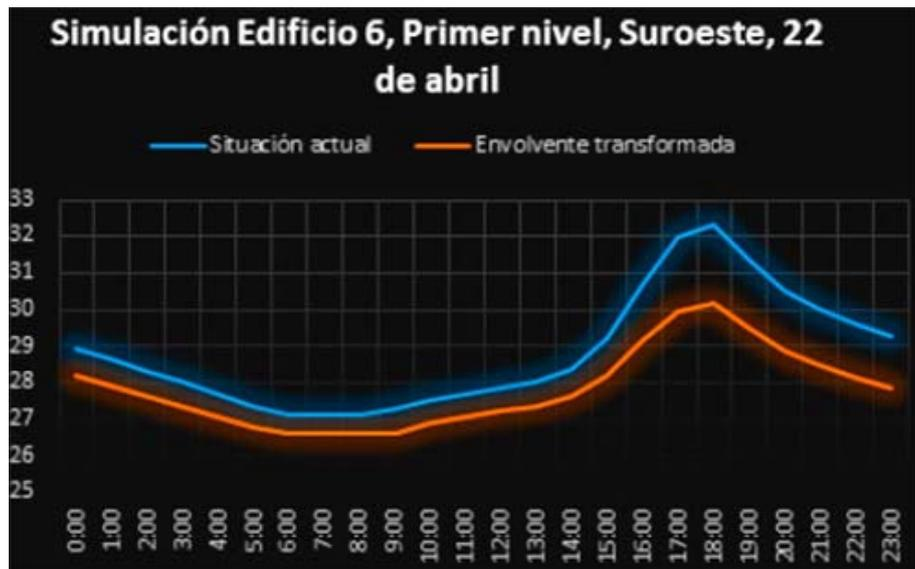
Fig. 27. Temperatura radiante simulada en las aulas del primer nivel del edificio 6 orientadas al suroeste, con la envolvente original y transformada.
