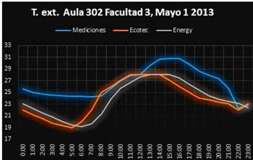
Fig. 7. Comparación entre las temperaturas exteriores medidas en el punto de referencia para el aula 302 del edificio 3 el 1ro de mayo y los valores de temperatura exterior simulados para ese mismo día con Ecotec y con Energy Plus
