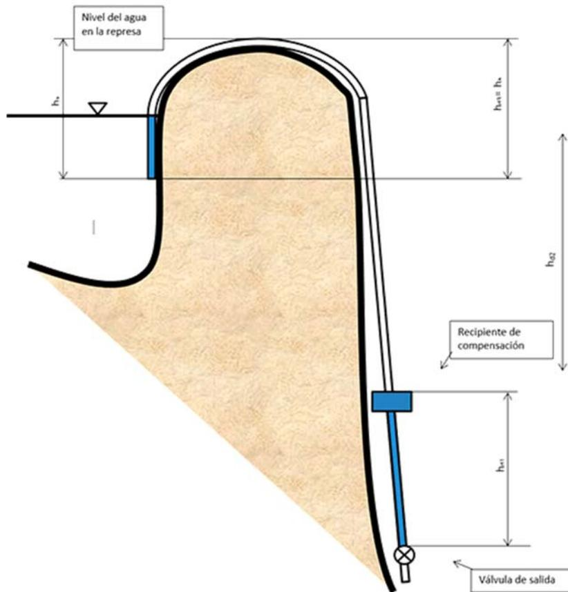
Fig. 1. Esquema de sifón con recipiente de compensación.
