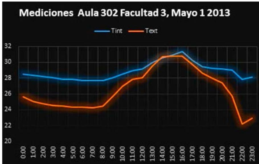
*Fig. 9. Temperaturas interiores y exteriores medidas en el aula 302 del edificio 3 el 1ro de mayo.*
