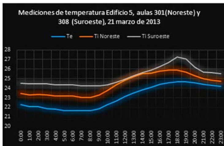
Fig. 14. Temperaturas medidas en el aula 301 orientada el noreste y el aula 308 orientada el noroeste en el edificio 5.
