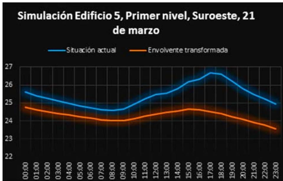
*Fig. 22. Temperatura radiante simulada en las aulas del primer nivel del edificio 5 orientadas al suroeste, con la envolvente original y modificada.*
