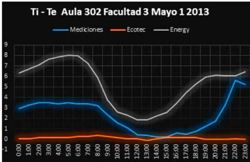
Fig. 11. Comparación entre la diferencia de temperaturas ( $t_i - t_e$ ) medidas y simuladas con Ecotec y con Energy Plus.
