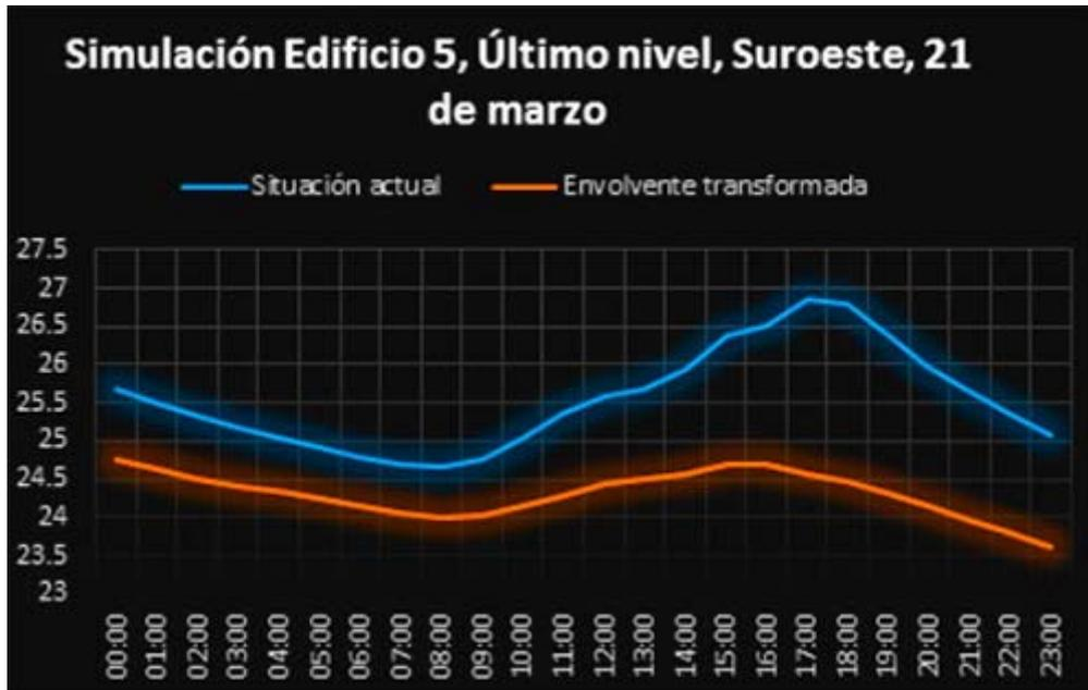
*Fig. 23. Temperatura radiante simulada en las aulas del último nivel del edificio 5 orientadas al suroeste, con la envolvente original y modificada.*
