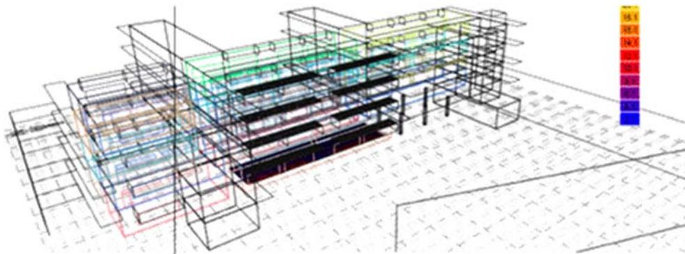
*Fig. 20. Simulación de iluminación de los laboratorios de la fachada ESE del edificio 3 con la envolvente transformada.*
