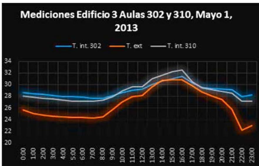
Fig. 12. Temperatura del aire en las aulas 302 (intermedia) y 310 (extrema) del edificio 3 con respecto a la referencia exterior.
