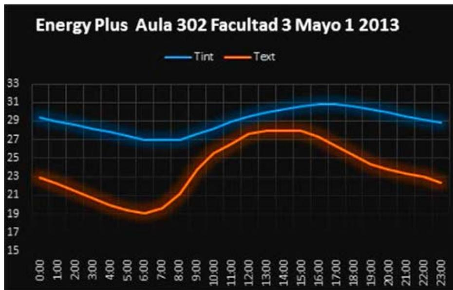
*Fig. 10. Temperaturas interiores y exteriores simuladas con Energy Plus*
