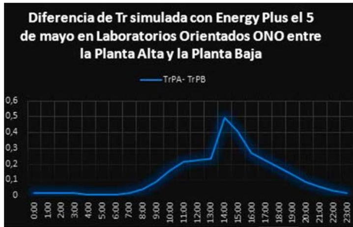
Fig. 13. Diferencia de las temperaturas simuladas en laboratorios orientados al ONO en la planta alta con respecto a la planta baja.
