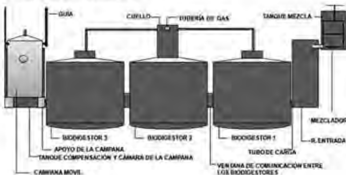
Fig. 5. Objetos de obras construidos en el polígono de biogás en Faesda y una vista longitudinal de los biodigestores.
