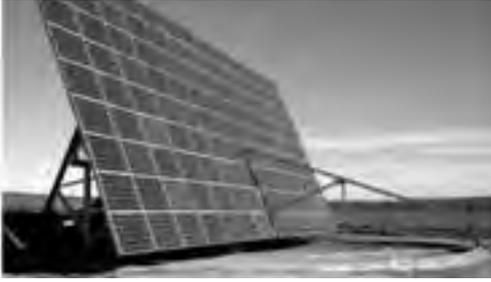
Fig. 2. Ejemplo de un eje vertical.
