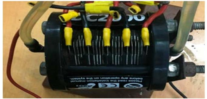
Fig. 4. Instalación de conectores en el electrolizador.
