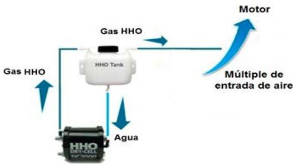
Fig. 9. Esquema básico del sistema de generación de HHO.
