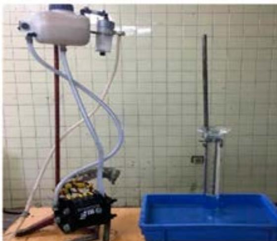
Fig. 10. Sistema de medición de la producción de gas.
