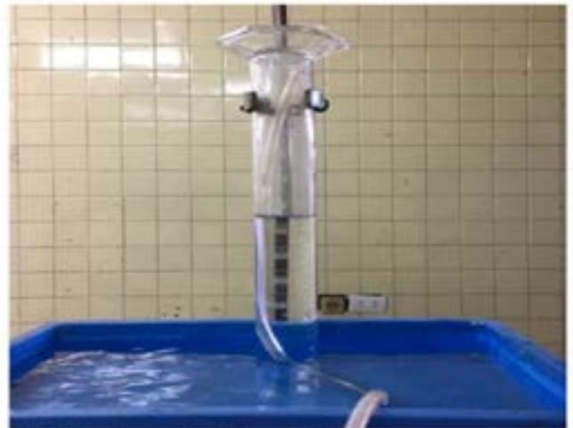
Fig. 11. Uso de probeta invertida como instrumento de medición.
