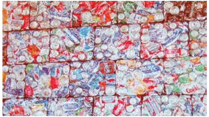
Fig. 5. Enchapes de paneles realizados con latas recicladas.
