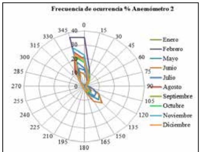
Fig. 12. Distribución por rumbos por hora en el Anemómetro No. 2.
