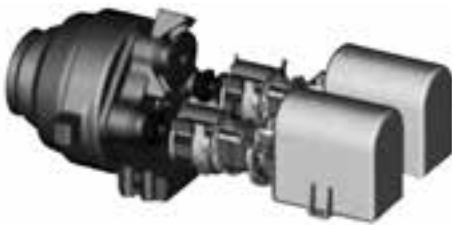
Fig. 4. Diseño del aerogenerador Bard 6,5 MW con transmisión normal doble salida.
