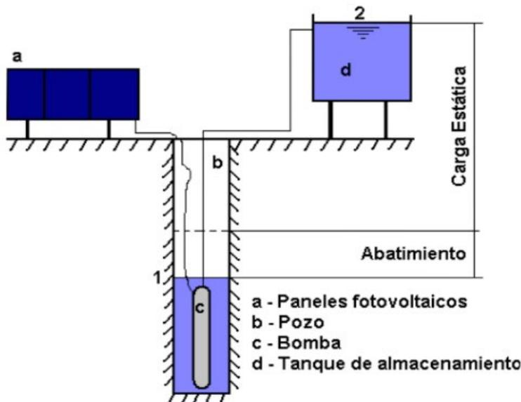
Fig. 3. Cargas a vencer por el sistema.
