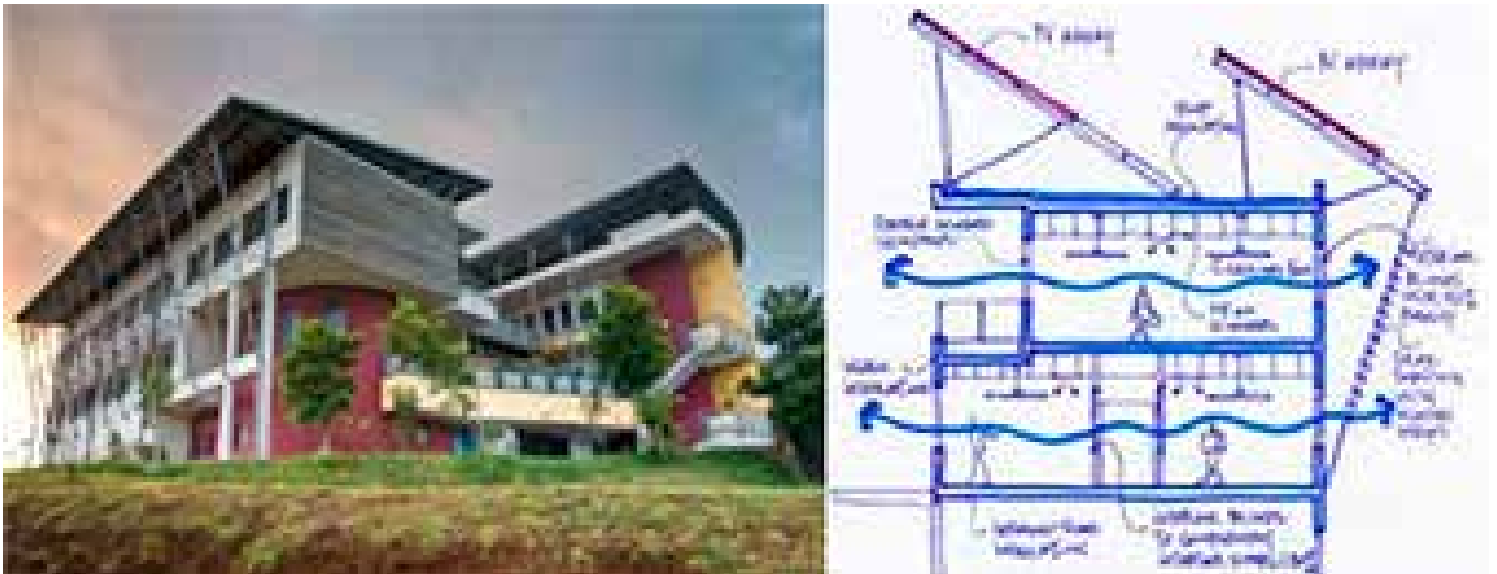
Fig. 1. Centro Educativo ENERPOS, Isla La Reunión. Edificio y esquema de principales soluciones [Franco, 2016].
