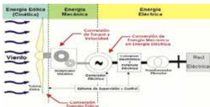
Fig. 4. Principio de funcionamiento de un aerogenerador.
