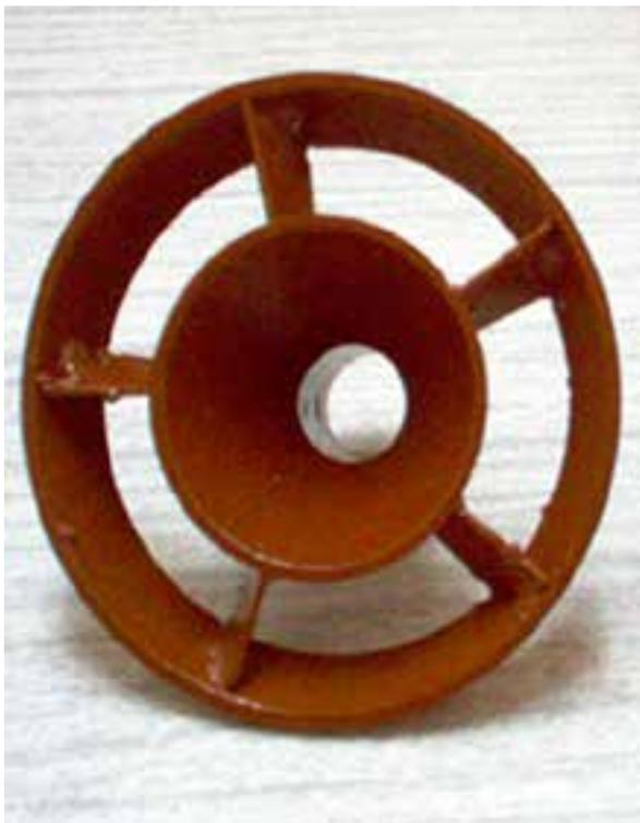
Fig. 1. Dispositivo estabilizador de doble cono. (Fuente [Rodríguez, 1988]).
