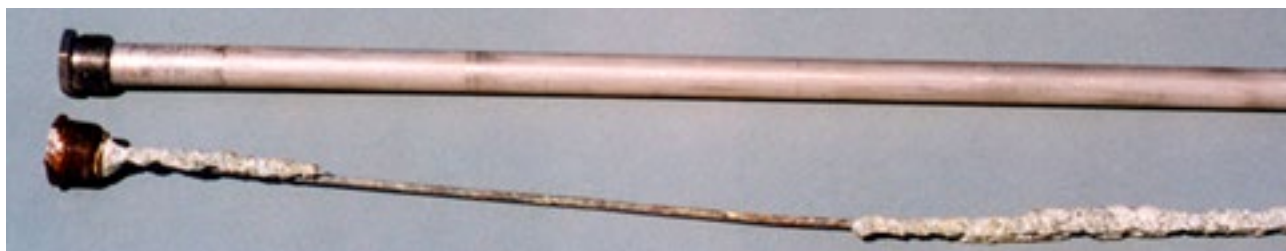
Fig. 21. Ánodo de magnesio (arriba nuevo, abajo agotado).
