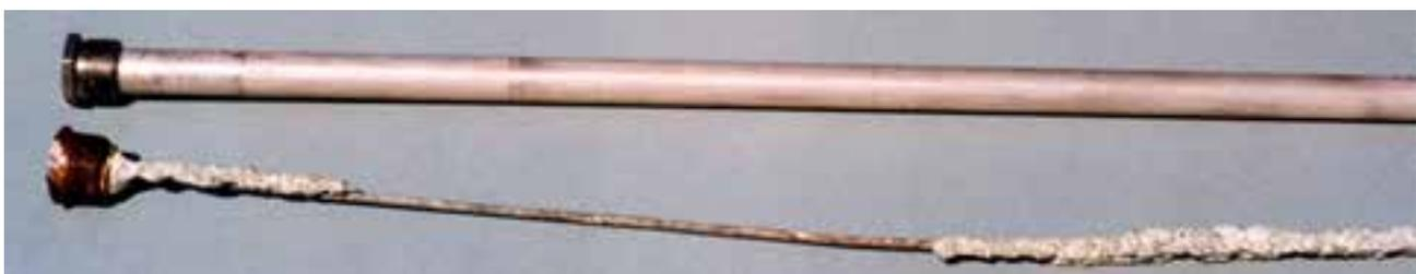
Fig. 21. Ánodo de magnesio (arriba nuevo, abajo agotado).
