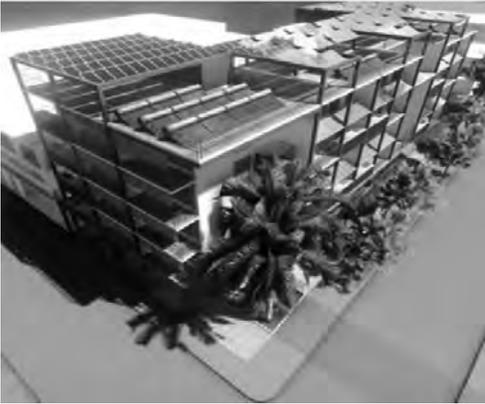
Fig. 2. Paneles fotovoltaicos como protección solar a la pared y en doble cubierta.
