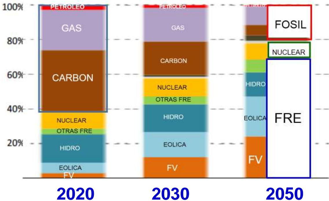
Se muestra que la fósil disminuye hasta un 20 %, algo más del gas, seguido del carbón y el sombreado en negro con captura de CO<sup>2</sup>. El aporte FV + Eólico es de un 48 %, repartido aproximadamente en la mitad para cada uno, o sea, la FV estaría en un 24 % en 2050.
