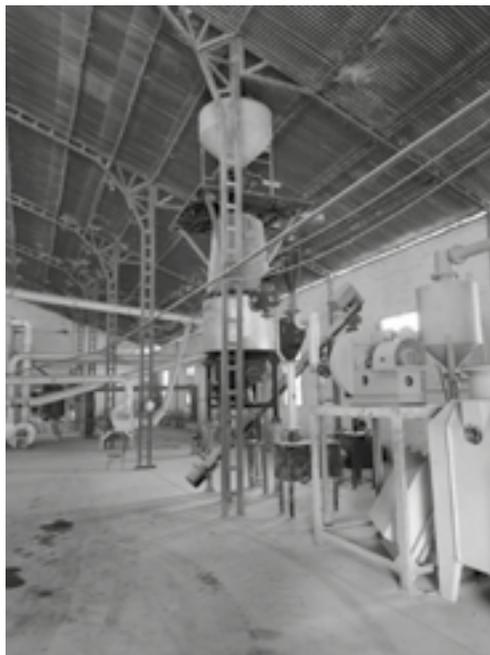
Fig. 2. Gasificador del molino arrocero.
