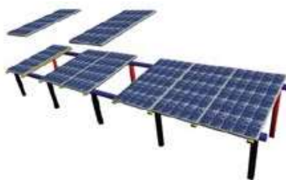
Fig. 4. Colocación de paneles sobre la estructura.
