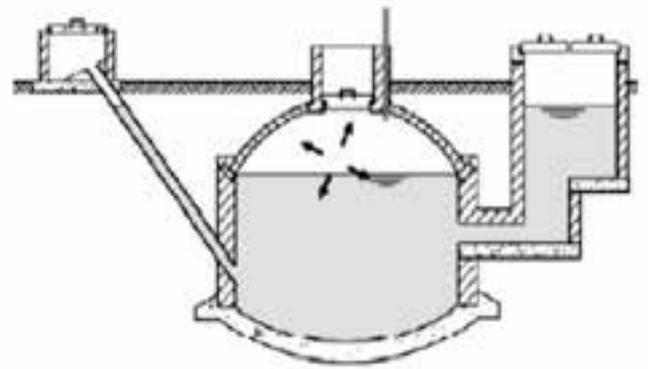
Fig. 3. Dimensionamiento para la excavación del biodigestor de cúpula fija (50 m<sup>3</sup>) a instalar en el escenario productivo (Guardado, 2007).
