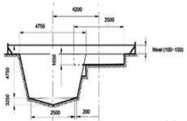
Fig. 2. Dimensionamiento y vistas superior y frontal del biodigestor de cúpula fija (50 m<sup>3</sup>) a instalar en el escenario productivo (Guardado, 2007).
