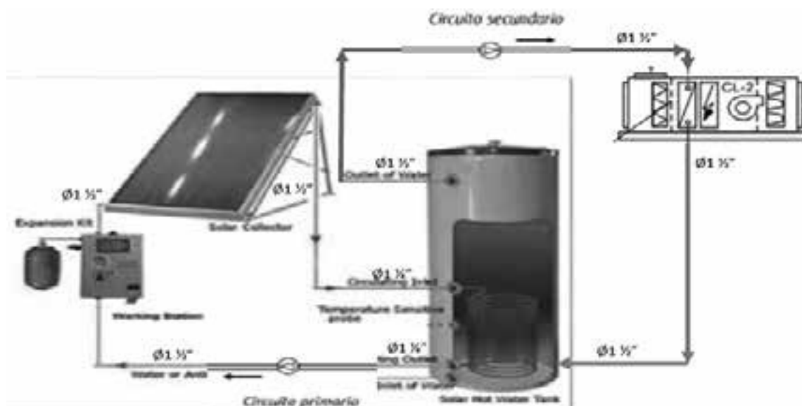
Fig. 5. Esquema de agua caliente de la instalación.
