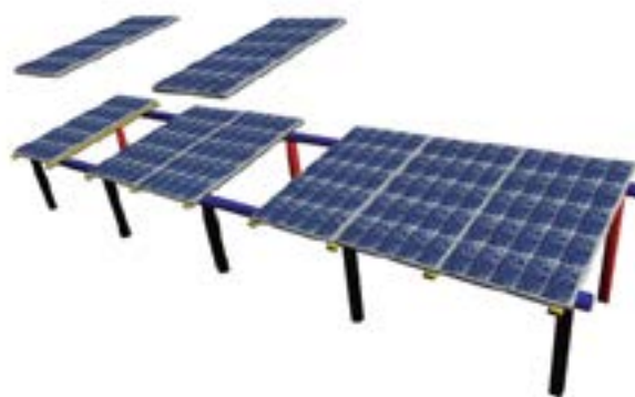
Fig. 4. Colocación de paneles sobre la estructura.
