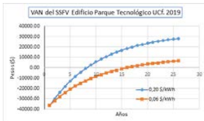
Fig. 6. VAN y PRI del sistema solar fotovoltaico propuesto.
