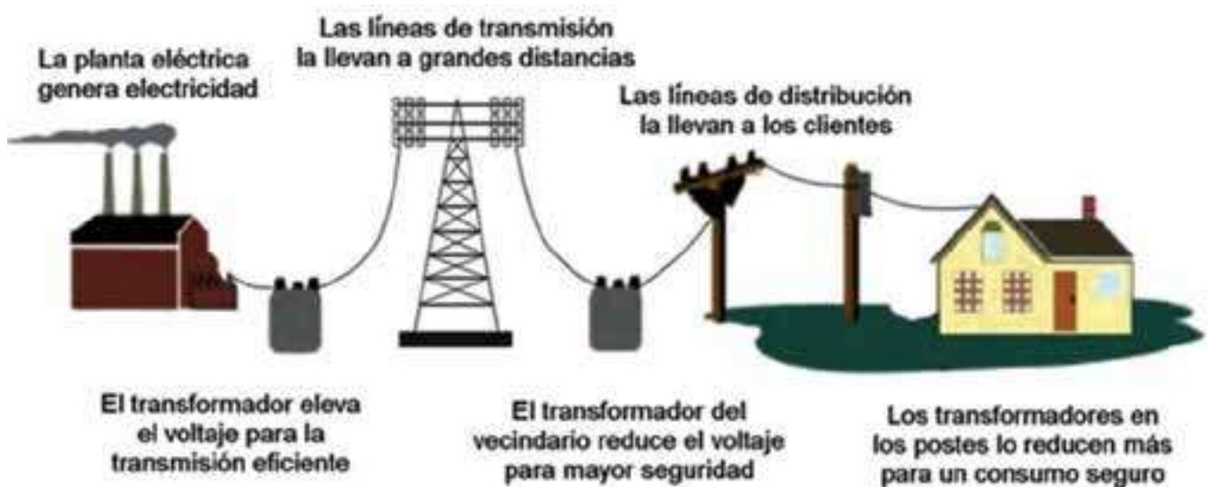
Fig. 1. Funcionamiento de una red eléctrica convencional.
