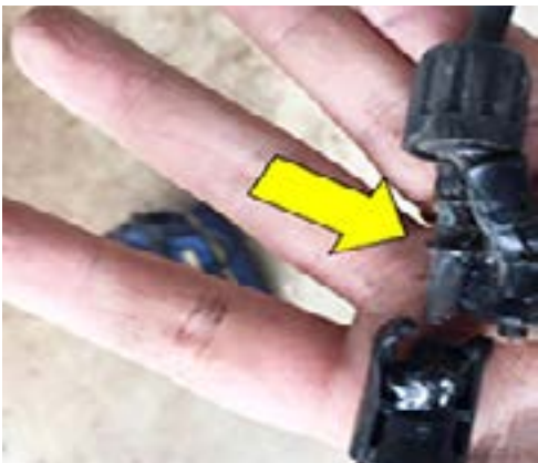
Fig. 7. Conector de un módulo solar fotovoltaico dañado.
