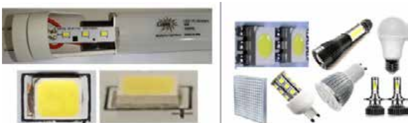
Fig. 6. Interior de una lámpara LED y ampliaciones de las vistas superior y lateral de los dispositivos que la componen. A la derecha se muestran otros dispositivos que usan iluminación LED.
