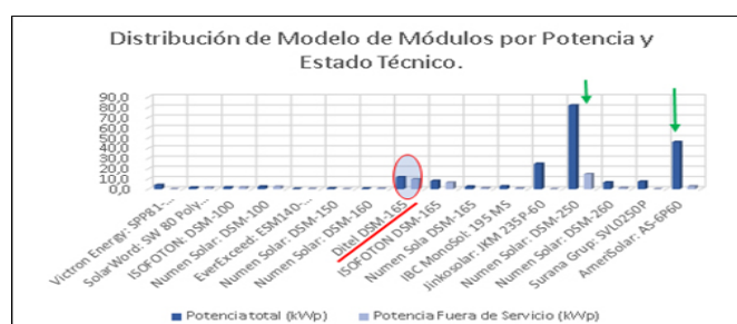
Fig. 4. Gráfico de Distribución de potencia y estado de técnico por modelo de módulos.
