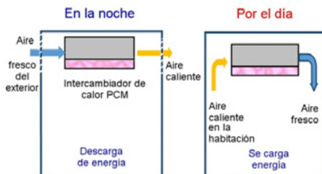
Fig. 2. Proceso de emisión y absorción de energía. Por la noche se abre el intercambio con el exterior y se cierra al llegar el día si el aire que circula es caliente. Al absorber el calor de la habitación, la temperatura se reduce. El aire caliente, menos denso, tiende a subir al techo de manera espontánea.
