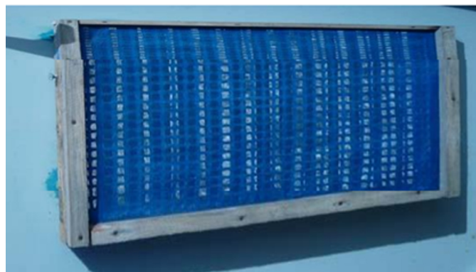
Fig. 4. Malla colocada para filtrar el aire que entra en el interior del aerogenerador (Piferrer, 2013).
